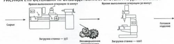
РИСУНОК 1: ПРОСТЕЙШАЯ ПРОИЗВОДСТВЕННАЯ СИСТЕМА ИЗ ДВУХ СТАНКОВ
